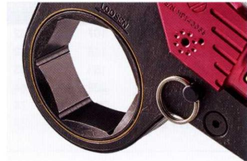
Изделия серии XLCT поставляются со сменными кассетами для работы с болтами с шести- и двенадцатигранной головкой, с шестигранным и квадратным приводом, кассетами с рабочим элементом для захвата двух параллельных фасок болта. Возможны и многие другие конфигурации, что значительно упрощает выполнение даже самых сложных задач при работе с резьбовыми соединениями.
