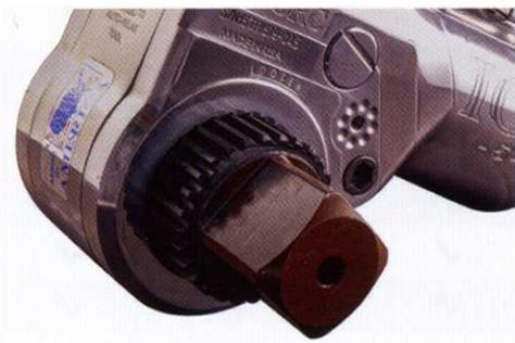
Изделия серии ICE разблокируются автоматически при блокировке на болте. Это обеспечивает меньшее количество незапланированных перерывов в процессе работы с резьбовыми соединениями.
