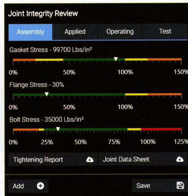
Система контроля целостности соединений позволяет легко определить необходимые уровни нагрузки на все компоненты при сборке и в ходе работы. Технические предупреждения позволяют получить мгновенные рекомендации касательно целостности соединений. Система обеспечивает значительное снижение риска утечки углеводородов и повреждения фланцев с течением времени.
