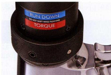
Простой поворот регулятора, расположенного на муфте патрона, переводит инструмент из режима высокоскоростной затяжки в режим максимальной производительности с регулируемым крутящим моментом, что облегчает выбор нужного уровня мощности.
