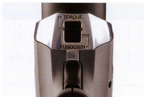
Переключатель позволяет переводить изделие серии LITHIUM из режима высокоскоростного затягивания в режим для окончательной затяжки, устраняя тем самым потребность в использовании нескольких систем одновременно. Высокоточный редуктор обеспечивает постоянную мощность без вибрации и шума, свойственного пневмомолоткам. Регулировка мощности осуществляется при помощи цифрового индикатора на торце инструмента и обеспечивает точную настройку крутящего момента.
