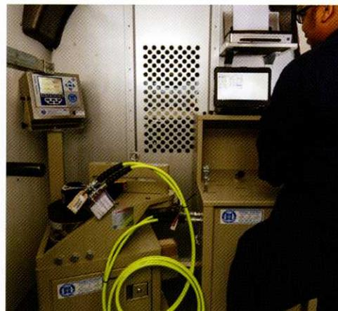
Наша мобильная калибровочная лаборатория осуществляет калибровку на вашей территории ручных динамометрических ключей, а также гидравлических, пневматических и электрических инструментов с крутящим моментом до 27 100 Нм. Если вам потребуется произвести калибровку более крупных инструментов, наши специалисты заберут ваше оборудование, а затем доставят вам его обратно.
