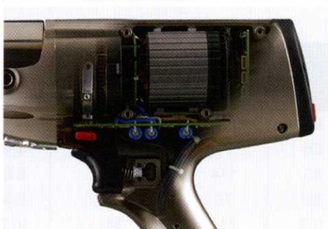
В инструменте используется совершенно новый бесщеточный двигатель постоянного тока 36 В, который меньше нагревается, работает тише и имеет значительно более длительный срок службы.
