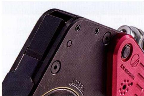
Как и изделия серии MXT, устройства XLCT также оснащены рычажком блокиратора храповика, облегчающим высвобождение инструмента после выполнения работы. (Также используется в системе STEALTH).
