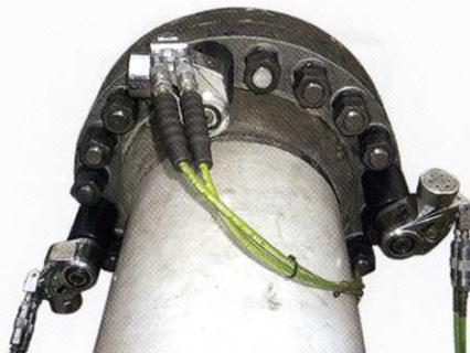
Компания HYTORC начинает поставлять гидравлические маслостанции с четырьмя соединениями и продвигает решение для одновременного использования нескольких инструментов, известное как Simultorc, которое обеспечивает равномерную и точную нагрузку на болт и сокращает время выполнения работ.
