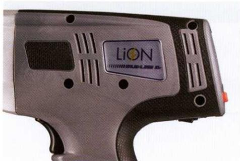
Промышленный редуктор, применяющийся в изделиях серии LION GUN, приводится в действие при помощи бесщеточного двигателя постоянного тока, что позволяет добиться необходимого крутящего момента быстрее и точнее по сравнению с ручными динамометрическими ключами, пневмомолотками и другими инструментами для работы с резьбовыми соединениями.
