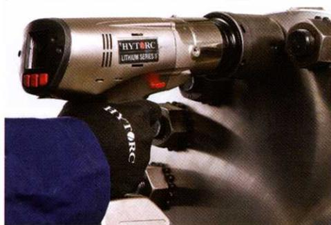
Система прямого измерения крутящего момента использует датчик на основе деформации в замкнутой системе контроля. Это обеспечивает более воспроизводимый крутящий момент.
