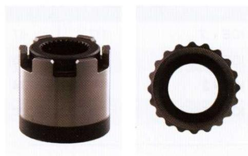
Изделия системы AVANTI оснащены запатентованным реакционным приводом (также используется в серии ICE). Он позволяет устраниить разрушающее воздействие скручивающего усилия, которое возникает при использовании других гайковёртов, оборудованных задним упорным рычагом.
