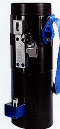
Однокомпонентные тензорные домкраты для затяжки резьбовых соединений воздушных турбин компании NYTORC обеспечивают непревзойденный уровень производительности. Однокомпонентные тензорные домкраты для затяжки резьбовых соединений воздушных турбин предназначены для работы с резьбовыми соединениями в местах с ограниченным верхним зазором, тогда как многокомпонентные тензорные домкраты используются для работы с резьбовыми соединениями с ограниченным радиальным зазором.
