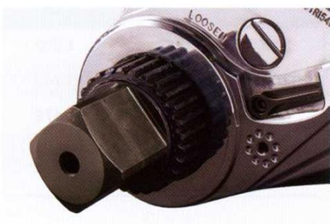
Изделия системы AVANTI оснащены запатентованным реакционным приводом (также используется в серии ICE). Он позволяет устранить разрушающее воздействие скручивающего усилия, которое возникает при использовании других гайковёртов, оборудованных задним упорным рычагом.
