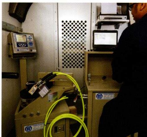
Наша мобильная калибровочная лаборатория осуществляет калибровку на вашей территории ручных динамометрических ключей, а также гидравлических, пневматических и электрических инструментов с крутящим моментом до 27 100 Нм. Если вам потребуется произвести калибровку более крупных инструментов, наши специалисты заберут ваше оборудование, а затем доставят вам его обратно.
