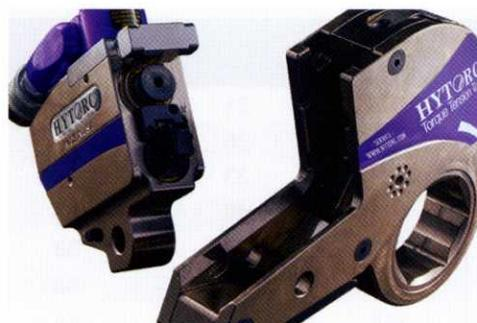
Запатентованная двухпоршневая конструкция изделий серии STEALTH с обеспечивает повышенную скорость работы по сравнению с другими низкопрофильными инструментами на рынке.
