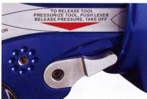
Изделия серии MXT стали первыми в отрасли инструментами, оснащенными рычажком блокиратора храповика, который позволяет высвободить инструмент в случае его блокировки. (Также применяется в изделиях серии AVANTI).
