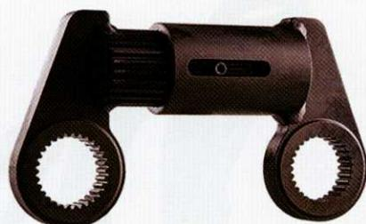
Контролируйте нагрузку на болты и повысьте уровень безопасности при помощи специального упорного рычага с двойным опорным механизмом для работ с кабель-каналами ветрогенераторов. Данное устройство позволяет снизить уровень боковой нагрузки, увеличивает срок службы гайковёртов и защищает фланец и прилагающие к нему гайки от повреждений, возникающих при использовании традиционных упоров.
