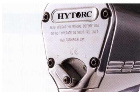
Для наибольшей надёжности соединения нагрузка на все болты должна быть распределена равномерно и точно. Изделия серии jGun SINGLE SPEED позволяют регулировать и повторять крутящий момент с высокой точностью, что обеспечивает надёжность резьбовых соединений и сохраняет заданный крутящий момент с течением времени.
