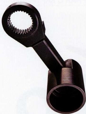
Контролируйте нагрузку на болты и повысьте уровень безопасности при помощи специального упорного рычага с двойным опорным механизмом для работ с кабель-каналами ветрогенераторов. Данное устройство позволяет снизить уровень боковой нагрузки, увеличивает срок службы гайковертов и защищает фланец и прилегающие к нему гайки от повреждений, возникающих при использовании традиционных упоров.
