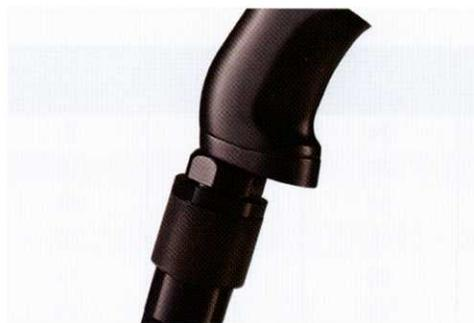
jGun DIGITAL – это уникальный в своем роде инструмент со встроенным регулятором подвода воздуха, который позволяет регулировать крутящий момент простым поворотом муфты в нижней части рукоятки. Механизм особенно удобен при переключении с затяжки на ослабление натяжения, что позволят быстро перейти на полную мощность, необходимую для развинчивания.
