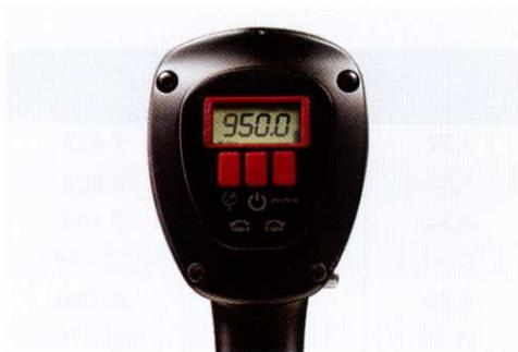
Изделие jGun DIGITAL – это первый в мире пневматический мультипликатор с регулируемым крутящим моментом и цифровым индикатором. Позволяет работать без использования узла подготовки воздуха. В отличие от других систем, требующих отдельного фильтра, регулятора давления и лубрикатора, запатентованная конструкция изделия jGun DIGITAL позволяет обходиться без них, что обеспечивает максимальную мобильность и удобство в работе.
